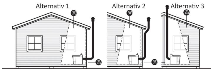
⚡ Friskluftsventil monteras på yttervägg! Om den placeras direkt bakom toaletten, under frånluftsroret, min Ø110 mm. Om den placeras någon annanstans på väggen min Ø160 mm.
