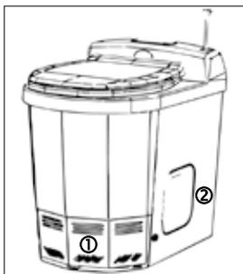
1. Frontplåt som lossas för att tömma asklåda
