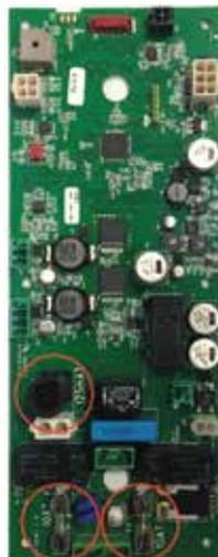
Säkringen till batteriet sitter på bakstycket.
